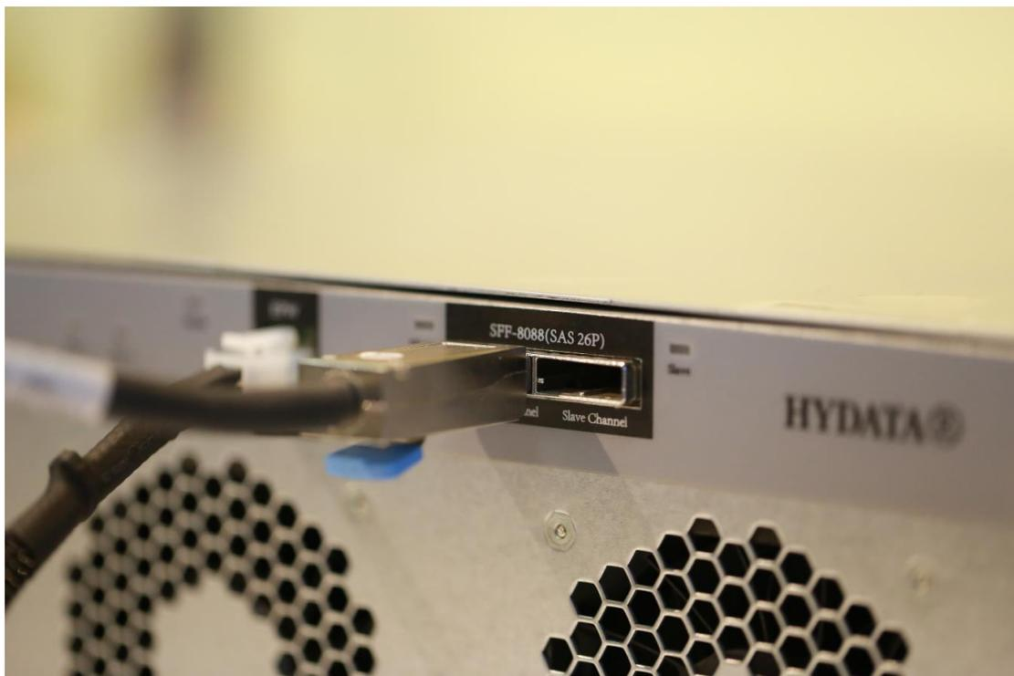
HRS-SAS 接口柜电缆连接后的全局样式, 上面是主机计算机, 下面是 HRS-SAS 接口柜。
